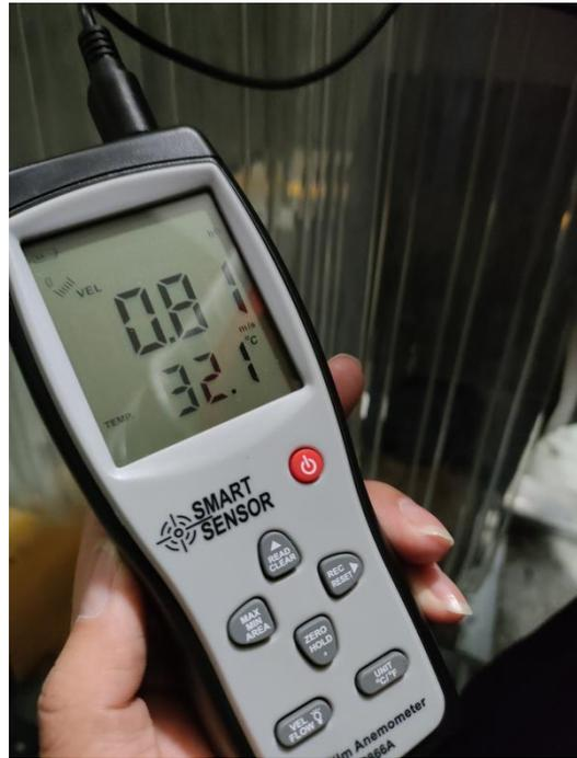
B6 车间集气罩风速实测照片
