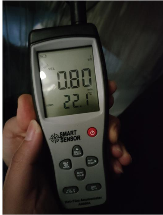
C5 车间集气罩风速实测照片
