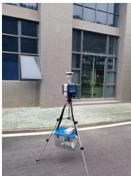
厂界下风向监控点 3#
